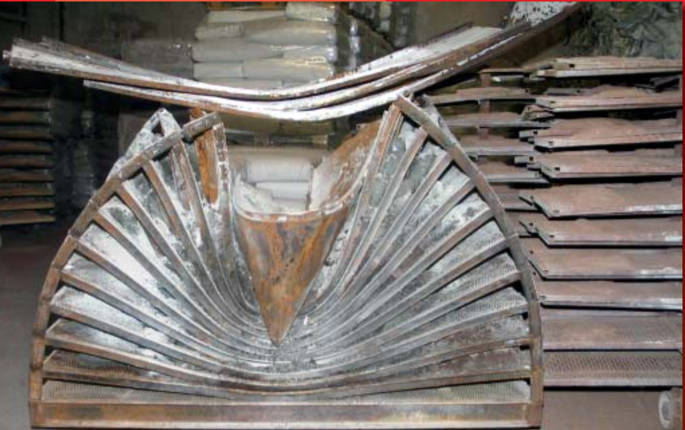
Bild 3: Ein Herdwagen, auf dem exotherme Platten gelagert waren. Das Metall war während des Brandes so weit erhitzt worden, dass es seine Formstabilität verlor. Auf den Herdwagen rechts und links waren zum Brandzeitpunkt Platten ohne exotherme Eigenschaften gelagert.
