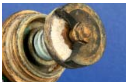
Bild 4 | Frische Bruchfläche auf der Dichtung des Ventils
