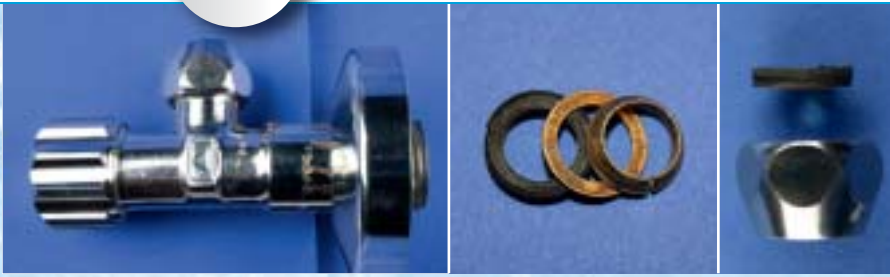
Bild 1 | Schaden auslösendes Eckventil mit unvollständiger Verschraubung. Das Anschlussrohr ist nur mit der Unterlegscheibe und einer Gummidichtung gehalten worden. Eine dauerhaft dichte Verbindung erfordert neben der Gummidichtung einen Druckring und einen geschlitzten Klemmring.
