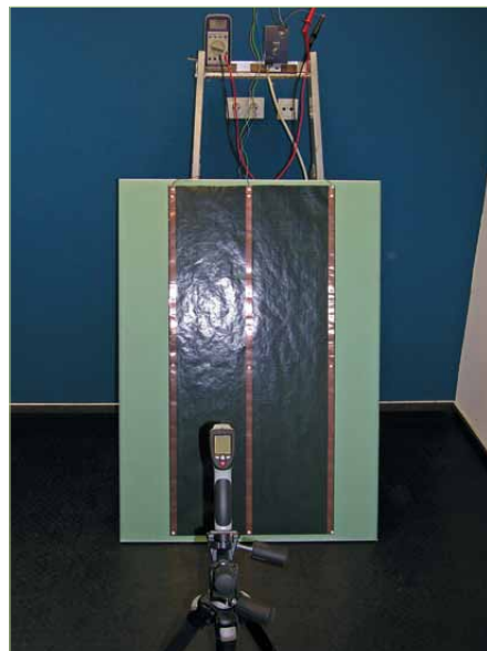
Bild 6 | Die Heizfolie wird mit der Betriebsspannung versorgt. Die Folie kann nach dem Erreichen der Höchsttemperatur problemlos angefasst werden.
