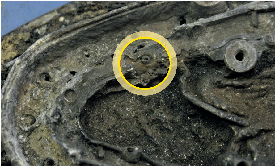
Bild 5 | Unterhalb der Durchbrennung liegt ein Schadensschwerpunkt am Heizkörper vor (Kreis).
