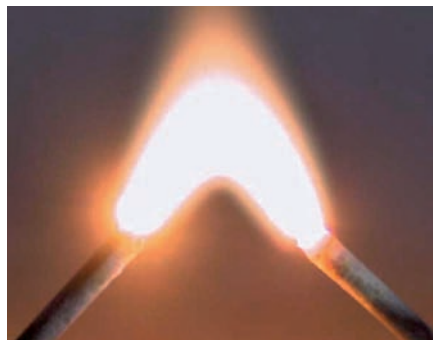
Bild 9 | Bei einem Lichtbogen treten Temperaturen von über 5.000 °C auf. Die enorme Energiefreisetzung entzündet benachbarte, brennbare Materialien (Foto Achim Grochowski).
