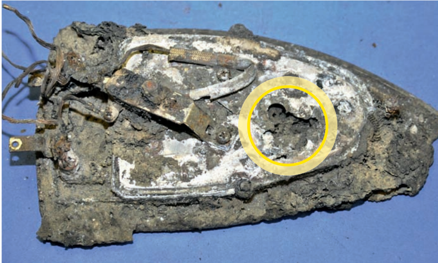
Bild 3 | Bei der Laboruntersuchung des Bügeleisens ist ein auffälliger Schadensschwerpunkt (Kreis) festzustellen.
