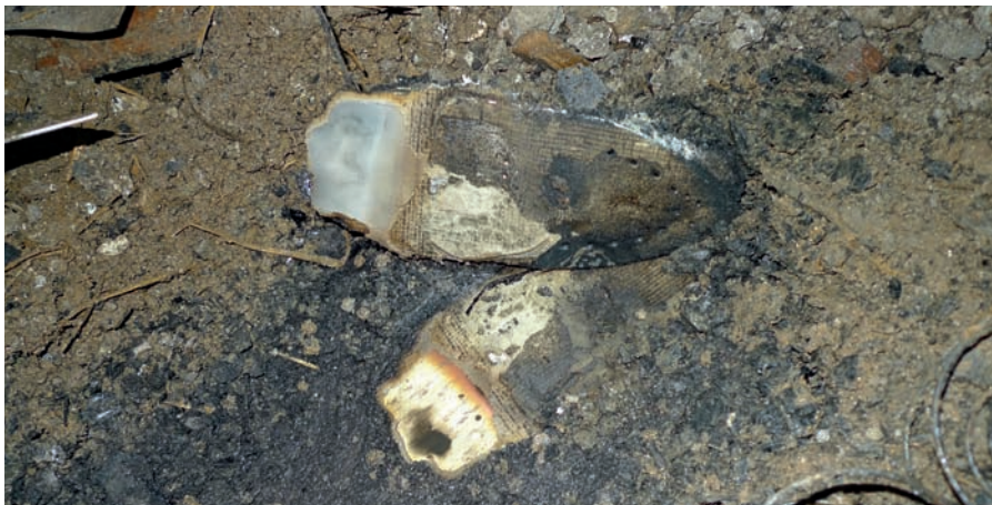
Bild 2 | Im Schadensschwerpunkt wird ein mit dem Bodenbelag verbackenes Bügeleisen aufgefunden.
