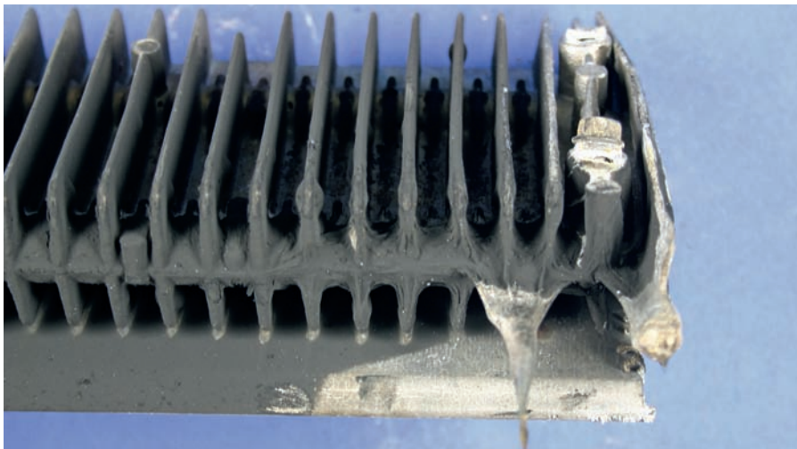
Bild 8 | Eines der neuartigen, schadenverursachenden Heizelemente aus Wäschetrocknern. Die Kombination aus Heizstab und Aluminiumheizkörper führte bei diversen Wäschetrocknern zu Bränden.
