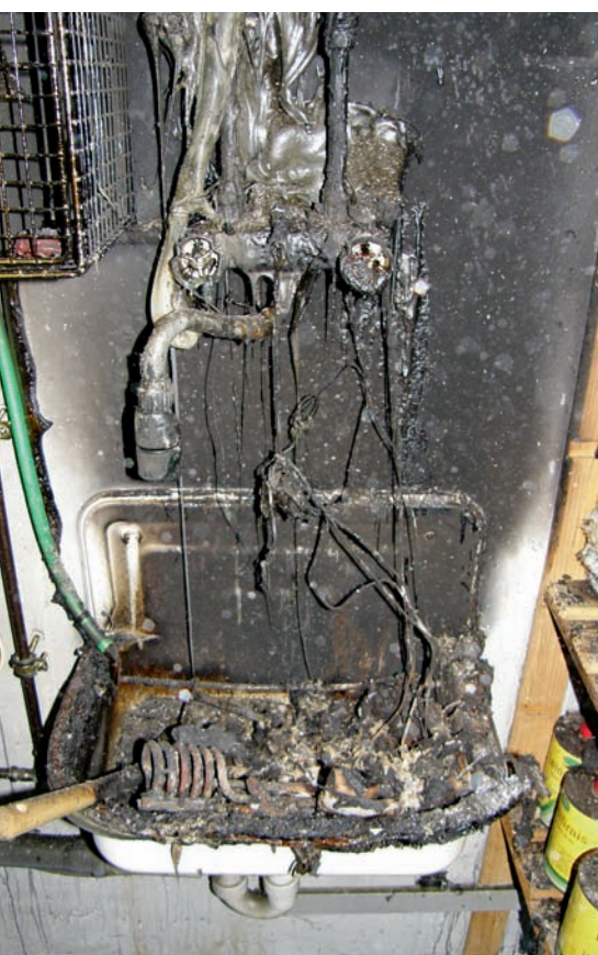
Bild 2 | Brandschwerpunkt mit Resten des Warmwasserbereiters
