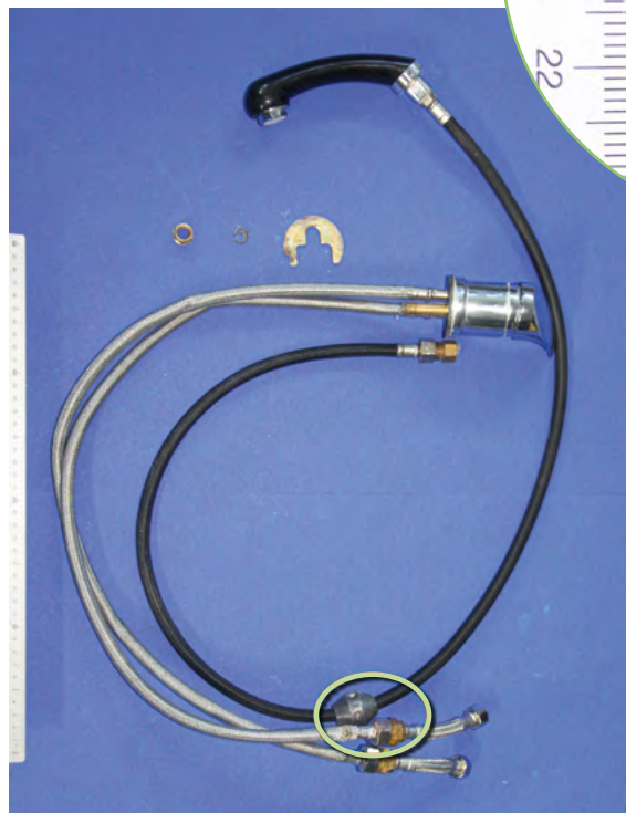
Bild 2 / Die Waschtischarmatur wurde für weitere Untersuchungen asserviert. Die Kaltwasserzuleitung war in der Nähe des Anschlussbereiches geplatzt (Markierung).
