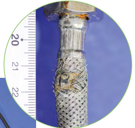
Bild 2 / Die Waschtischarmatur wurde für weitere Untersuchungen asserviert. Die Kaltwasserzuleitung war in der Nähe des Anschlussbereiches geplatzt (Markierung).
