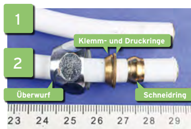
Bild 2 / Schlauch von der Schadenstelle (1) und zum Vergleich ein Schlauch samt den verwendeten Verbindungskomponenten von einem zweiten Wasserspender (2)
