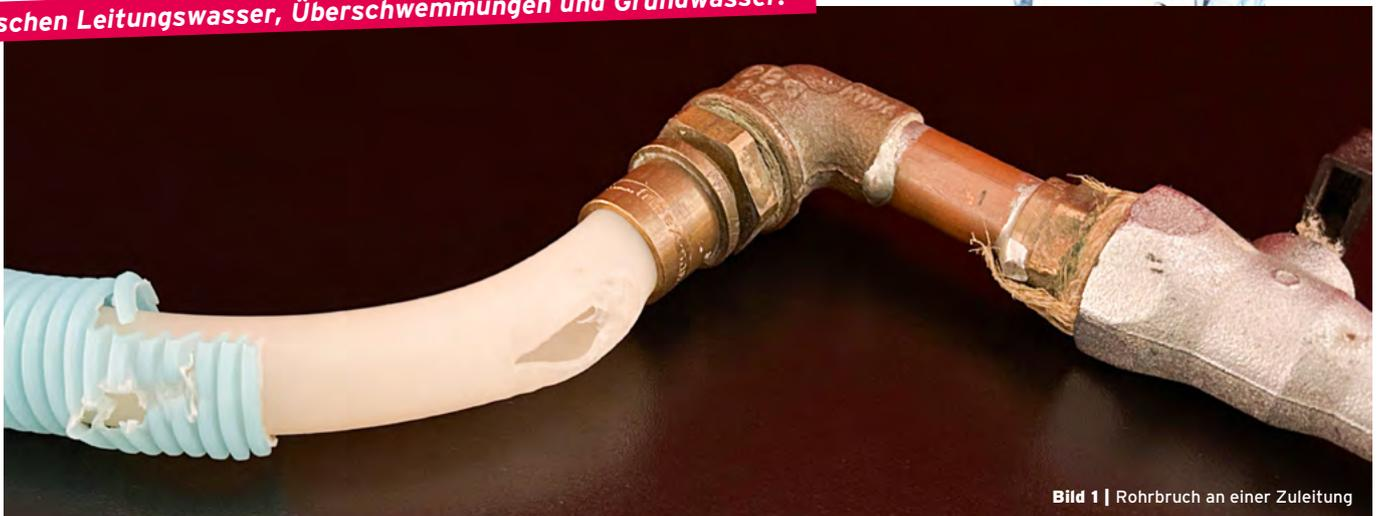
Bild 1 | Rohrbruch an einer Zuleitung
