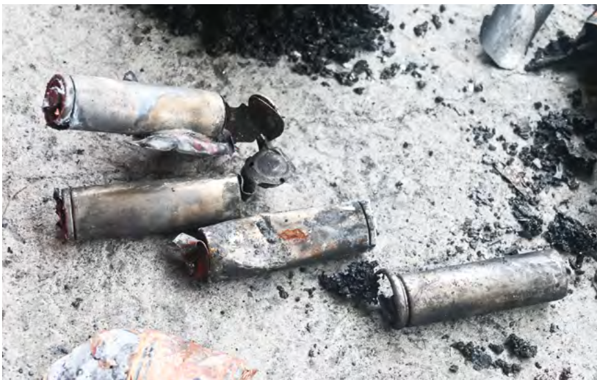
Bild 3 / Die Überreste der Zellen des zweiten durchgegangenen Akkus
