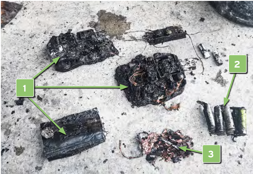
Bild 2 / Die drei vorgefundenen Ladegeräte (1), der Werkzeugakku mit den gut erhaltenen 18650er-Zellen (2) und die Reste des LiPo-Akkus (3)
