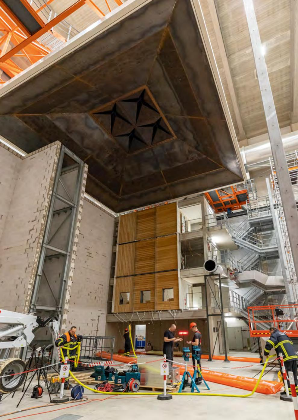
**Bild 2 /** Großkalorimeter (K3), bestehend aus dem Brandhaus (hier mit einem Prüfaufbau einer Holzfassade, rechts) und den Fassadenprüfständen (links)
