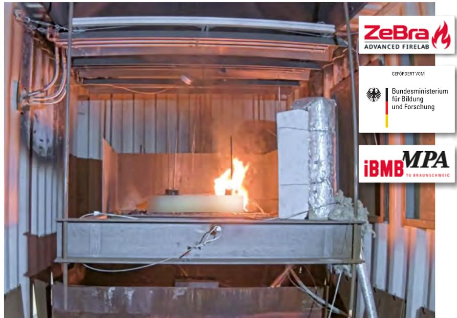
Bild 4 / Brandversuch mit E-Fahrzeug-Batteriemodul im Batteriekalorimeter
